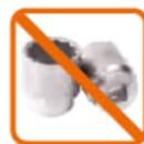
Не используйте стандартные торцевые головки с пневматическим ударным инструментом.
